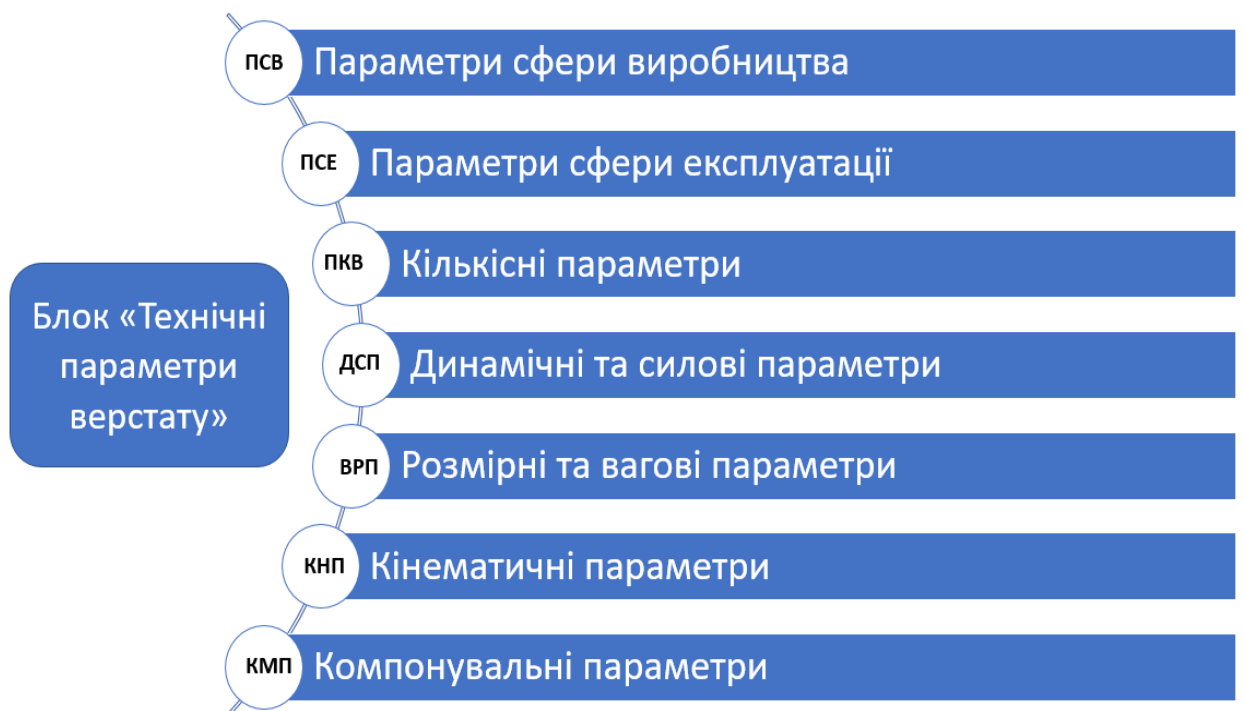
Рис. 3.2. Масиви, що входять до блоку «Технічні параметри верстату»
