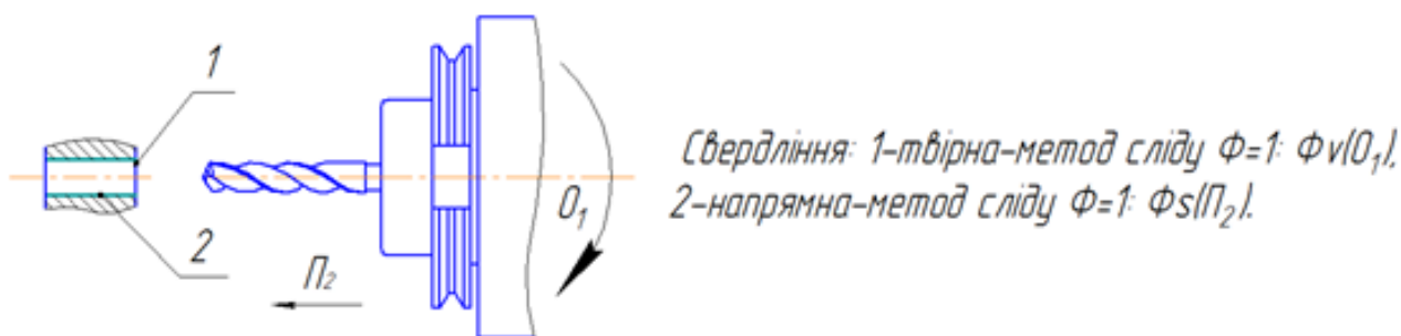
Рис. 2.5. ФУР при свердлінні отворів
