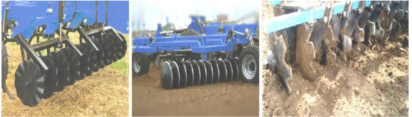
Рисунок 1.3 – Робочі органи комбінованих ґрунтообробних агрегатів АК-6 “Георгій”
