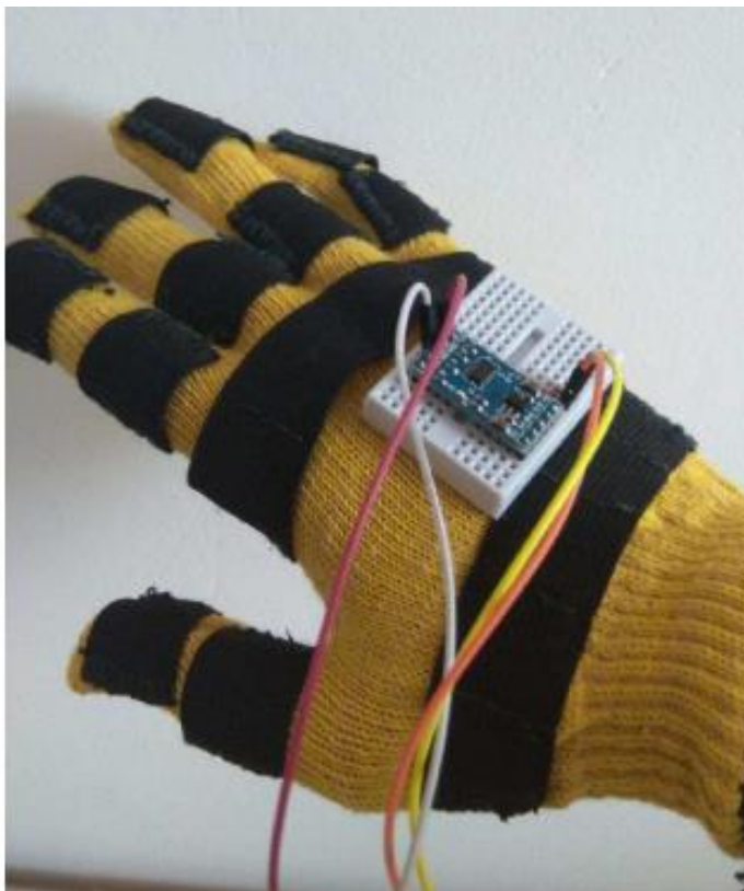
Рис. 3.11. Перевірка модуля акселерометра
