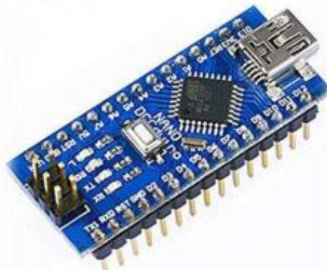
Рис. 2.13. Платформа Arduino Nano на основі мікроконтролера ATmega 328P
