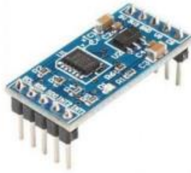
Рис. 2.15. Модуль акселерометра ADXL345
