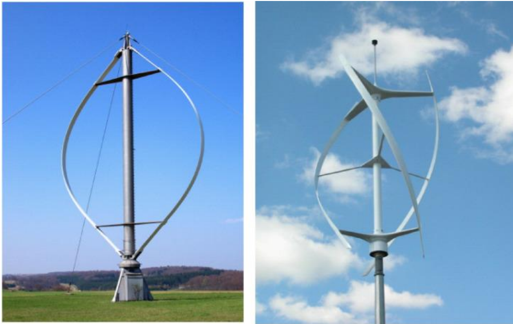
Рисунок 2.2 – Зовнішній вигляд вертикально-осьового вітроагрегату
