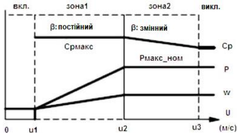
Рисунок 3.15 – Зони роботи ВЕУ та принцип зміни в них кута нахилу
