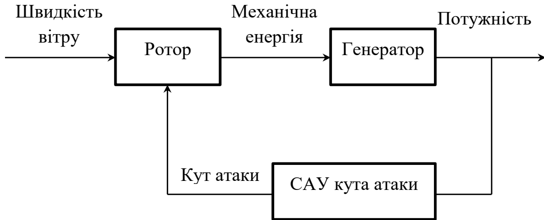
Рисунок 3.17 – Регулювання потужності турбіни
