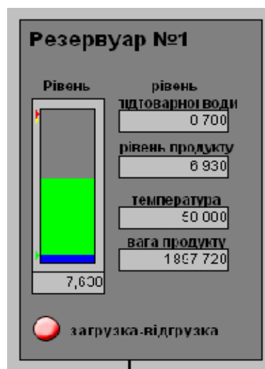
Рисунок 3.10 – Панель керування резервуаром
