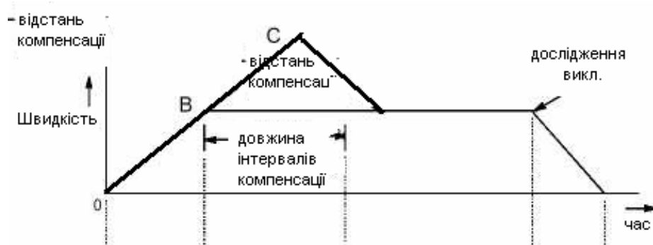
Рисунок 3.8 - Цикл прискорення / уповільнення при стеженні - ситуація 2, коли тривалість інтервалу компенсації дуже мала.
