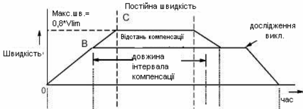
Рисунок 3.9 - Цикл прискорення / уповільнення при стеженні – ситуація з діючим обмеженням швидкості.
