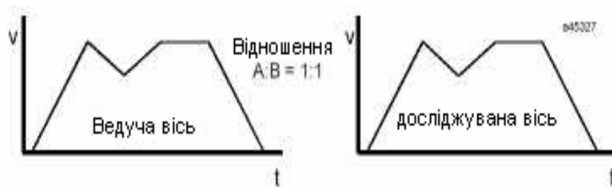
Рисунок 3.2 – Робота системи в режимі простого відтворення переміщення
