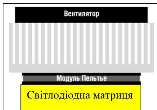
Рис 1.11 Типова схема охолодження світлодіодної матриці модулем Пельтьє.
