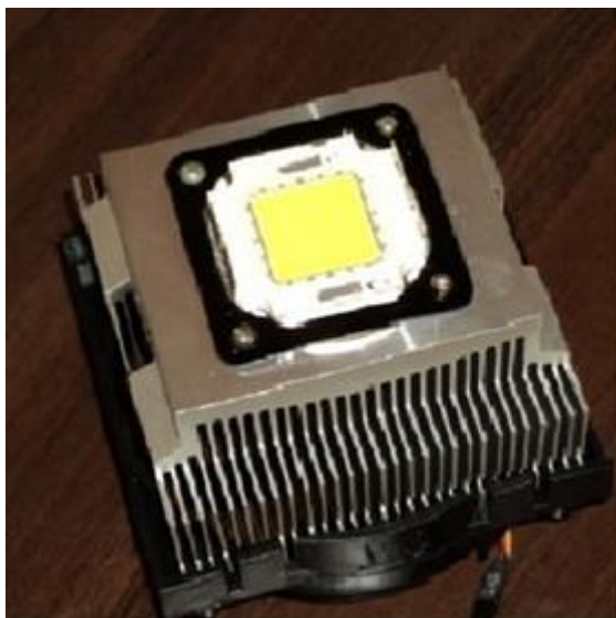
Рис. 1.7 Низькооборотний малошумний вентилятор в тандемі з радіатором
