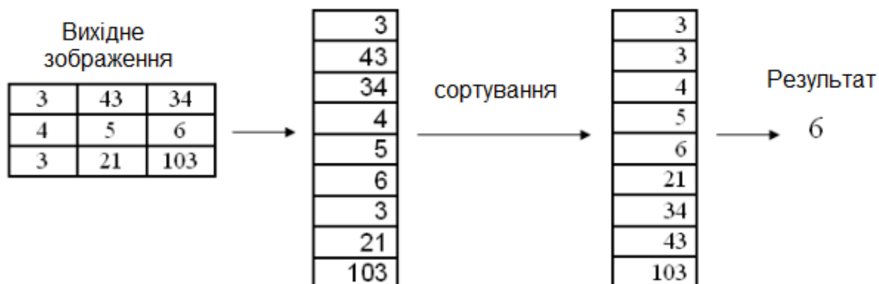
Рис. 1.6. Принцип зміни пікселів у роботі медіанного фільтра
