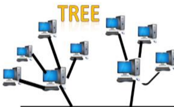
Рис. 1.5. Деревовидна топологія мережі
