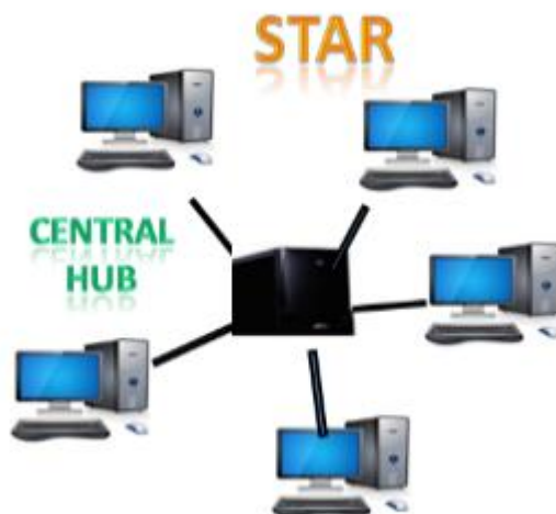
Рис. 1.4. Топологія типу «зірка»
