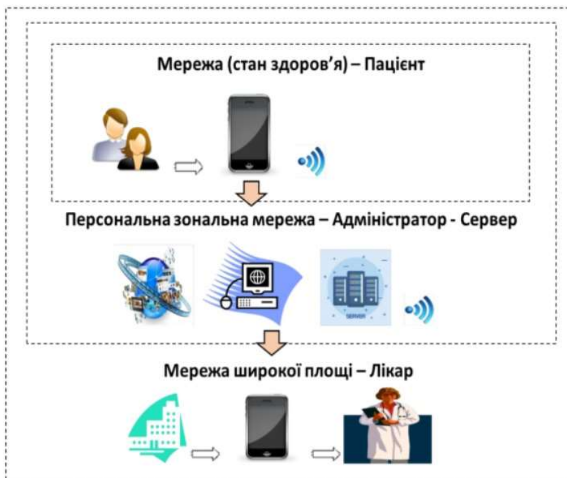
Рис. 1.1. Структура системи дистанційного моніторингу, оцінювання та прогнозування стану здоров'я пацієнтів [4]
