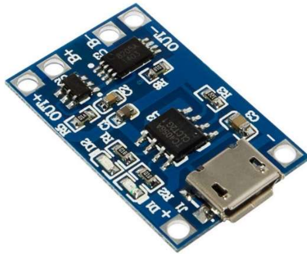
Рис. 2.11. Зовнішній вигляд TP4056
