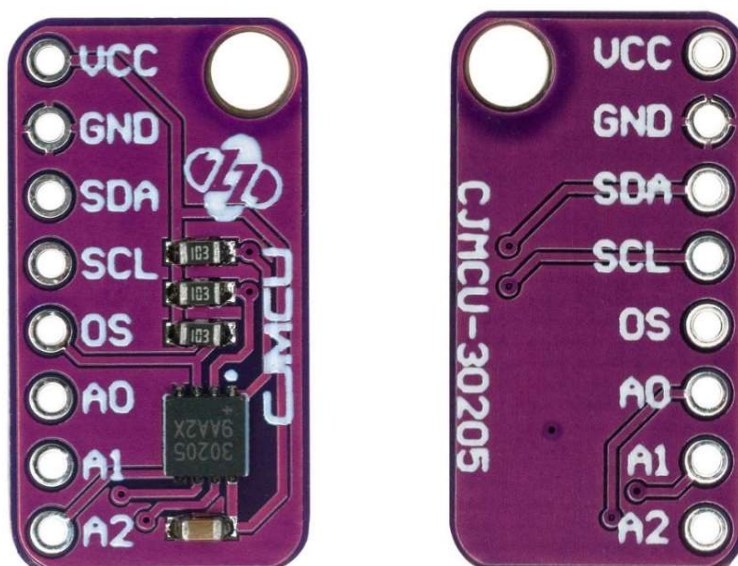
Рис. 2.9. Зовнішній вигляд давача MAX30205 температури тіла
