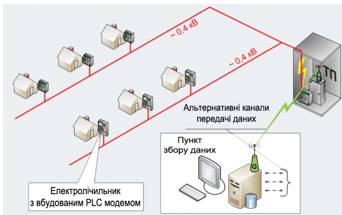
Рисунок 3.2 – Структура автоматизованої системи контролю та обліку електроенергії з передачею інформації через GSM.
