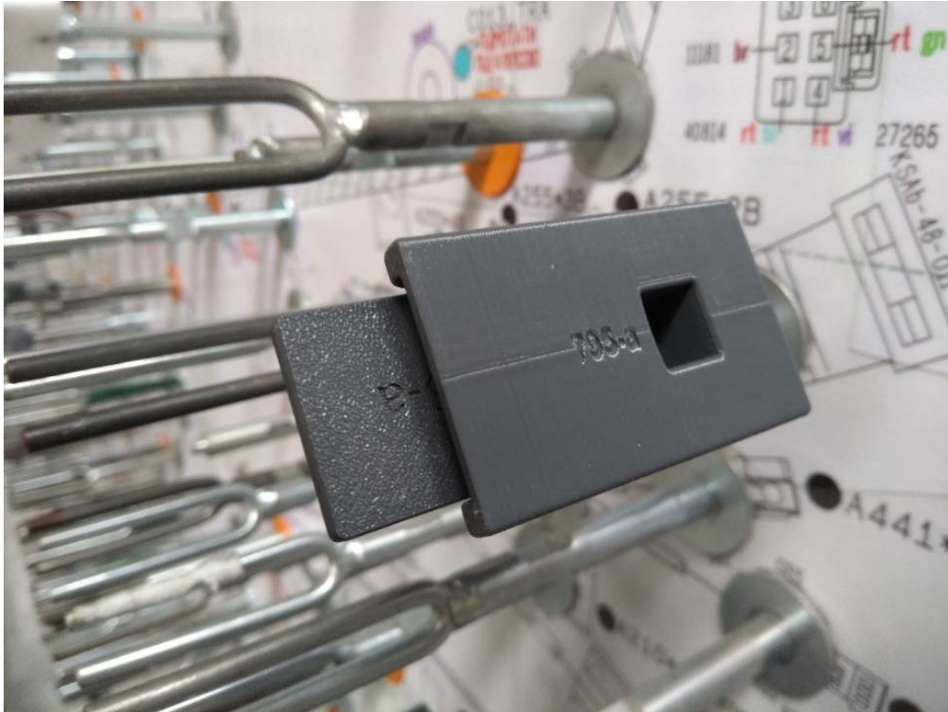
Рис.1. Гравіювання на збірній конструкції 3д деталей.
