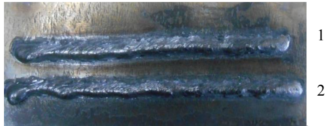
Рис.3. Горизонтальні валики, наплавлені на вертикальну площину самозахистним електродним дротом: 1- звичайним способом; 2 з дозованою подачею електродного дроту
