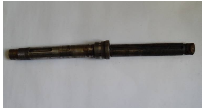
Рис. 3. Ескіз вала робочого органу екструдера: а) та загальний вигляд вала робочого органу екструдера б)
