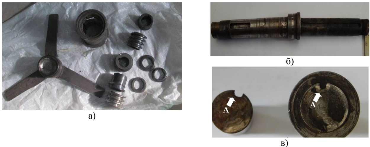
Рис. 2. Робочий орган екструдера – а, вал – б та поверхня зламу валу – в; А - місце зародження тріщини
