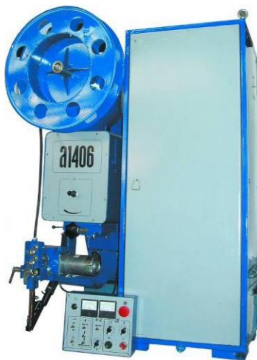
Рис. 2.5 - Підвісний автомат А-1406
