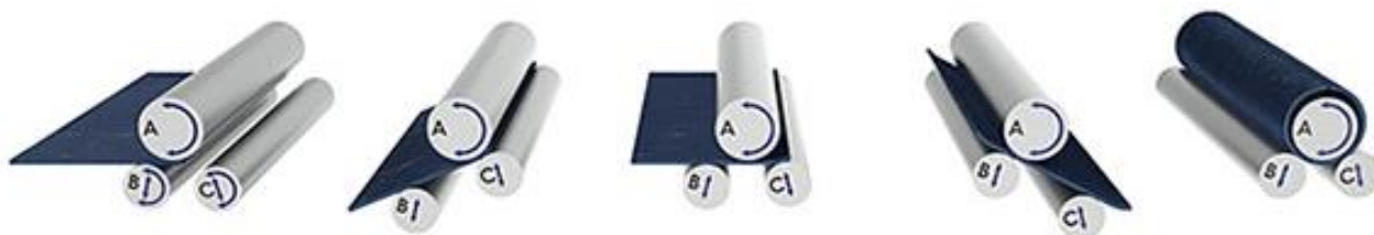
Рис. 2.15. – Вальцювання листового прокату [17]
