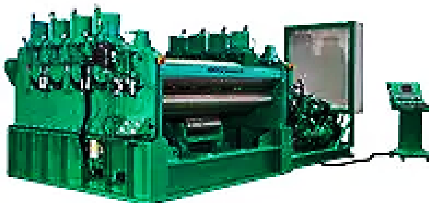
Рис. 2.11 – Загальний вигляд листопрямильної машини Vendmak BPSM 20/18
