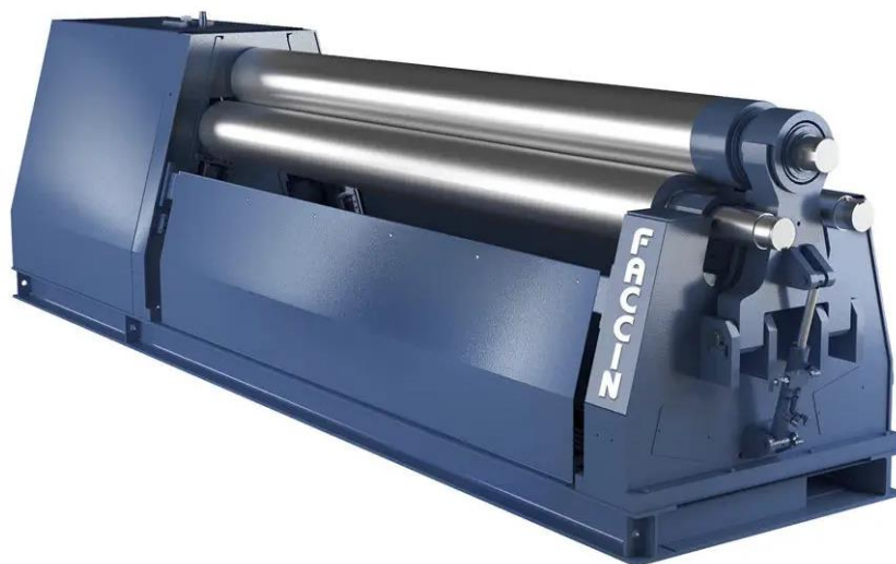
Рис. 2.16. – Загальний вигляд листозгинальної машини FACFIN [17]
