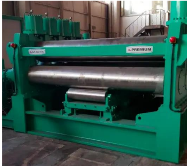
Рис. 2.10 - Листопрямильна машина Vendmak BPSM 20/18 [16]
