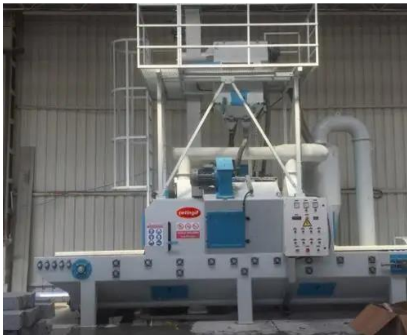
Рис. 2.14 - Дробострумінна установка SK-7 ÇETİNGİL[16]
