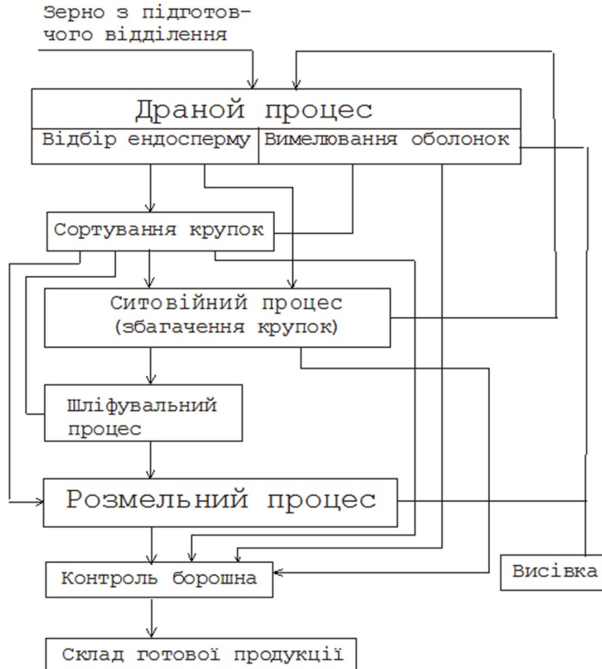
Рисунок 1. 1 – Принципова технологічна схема сортового помелу пшениці
