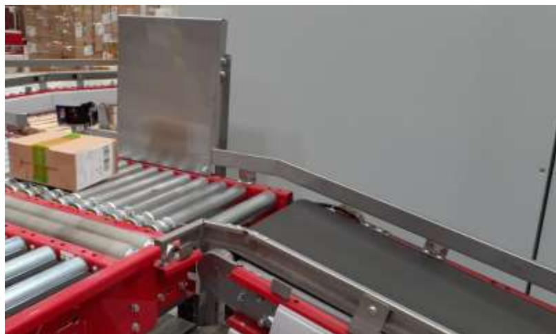
Рисунок 2.21 – Удосконалення 1 - металевий стабілізатор і гумова стрічка замість роликів в модулі, по якому посилки йдуть вгору.
