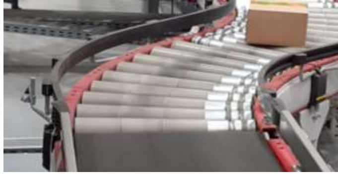
Рисунок 2.22 – Удосконалення 2 - встановлення більших пластикових накладок на ролики, що збільшують можливість випрямлення пакета на кривій
