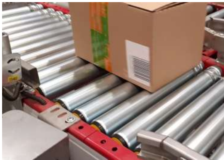
Рисунок 2.23 – Удосконалення 3 конвеєра - зменшення зазорів між роликами в модулі безпосередньо перед і на висоті сканера
