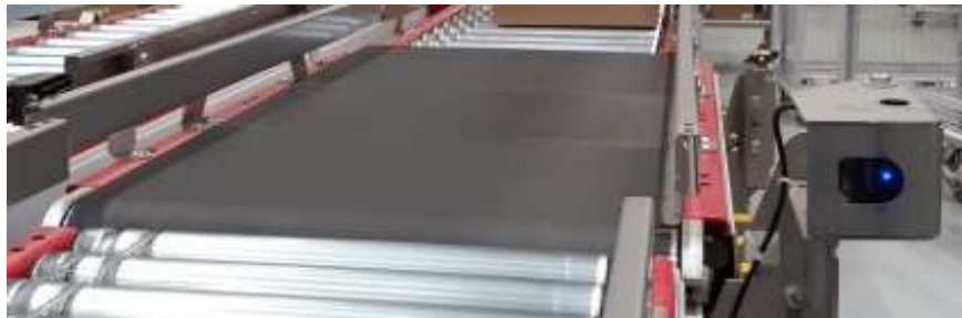
Рисунок 2.13 – Фрагмент модуля зі шкалою та сканером штрих-коду
