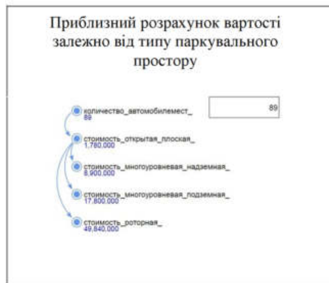
Рисунок 2.16 – Розрахунок приблизної вартості будівництва
