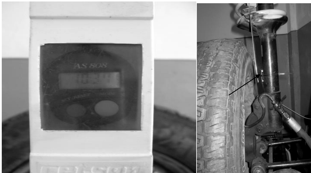
Рисунок 3.7 - Вимірювання швидкості обертання колеса.
