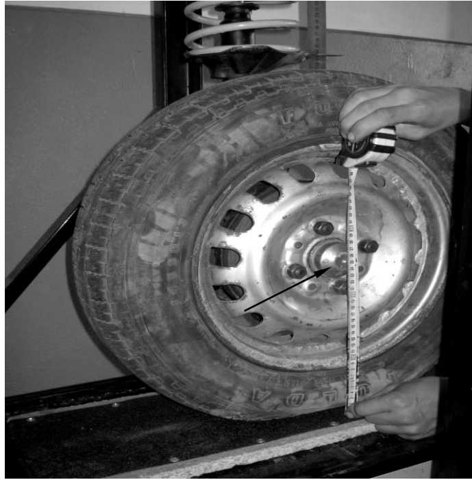
Рисунок 3.4 - Вимірювання статичного радіуса колеса.
