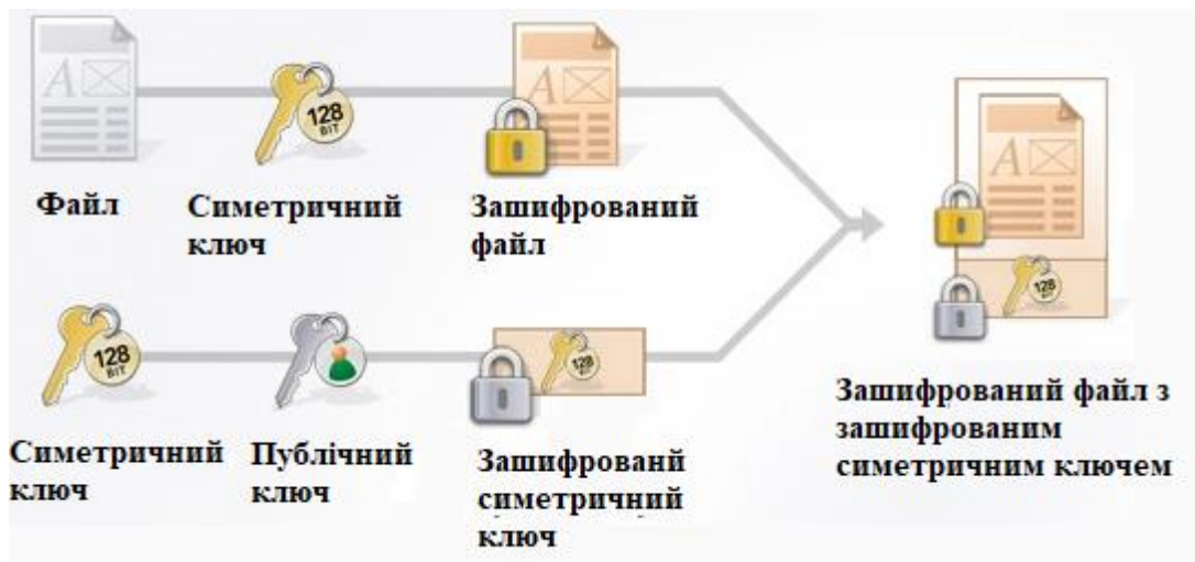
Рисунок 3.20 – Гібридна схема шифрування
