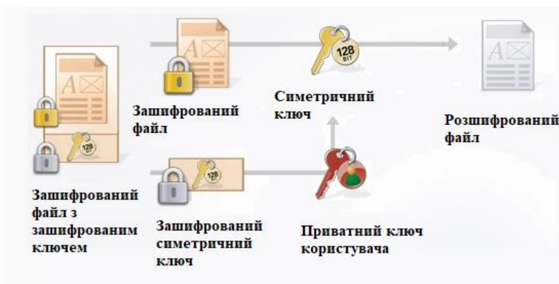
Рисунок 3.21 – Гібридна схема дешифрування
