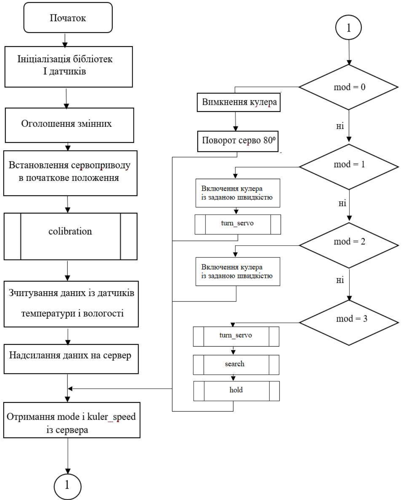
Рисунок 3.1 – Блок-схема алгоритму роботи системи керування самонавідним вентилятором
