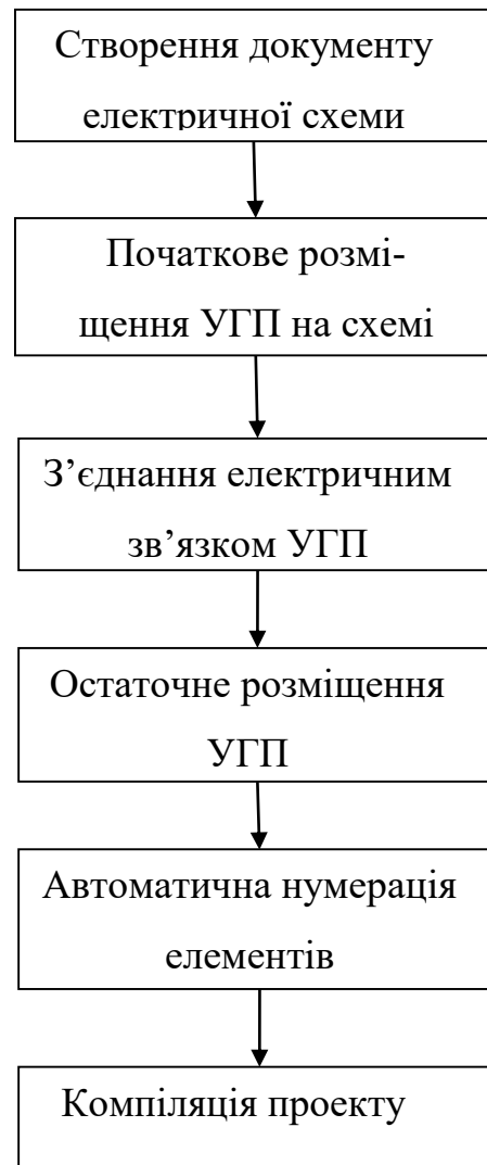
Рисунок 2.2 – Створення електричної принципової схеми в Altium Designer
