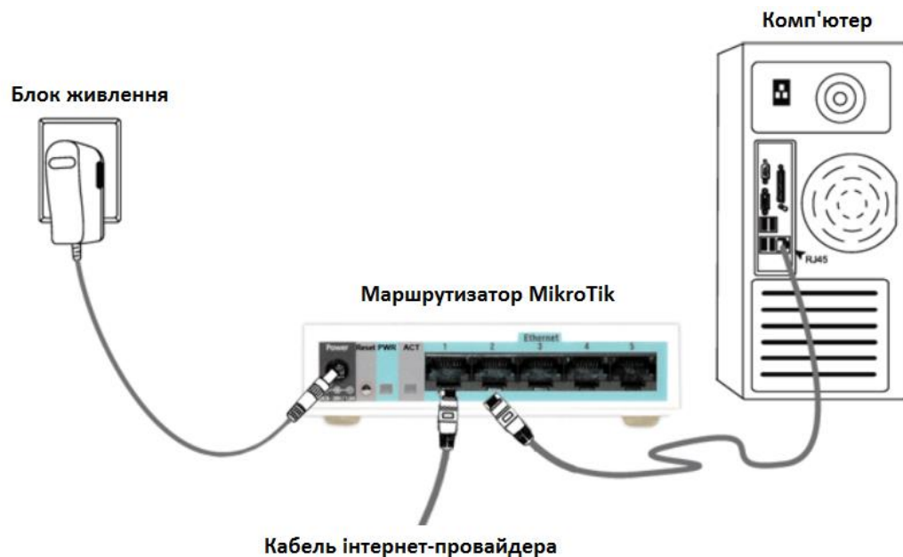
Рисунок 3.1 – Схема підключення маршрутизатора для базового налаштування
