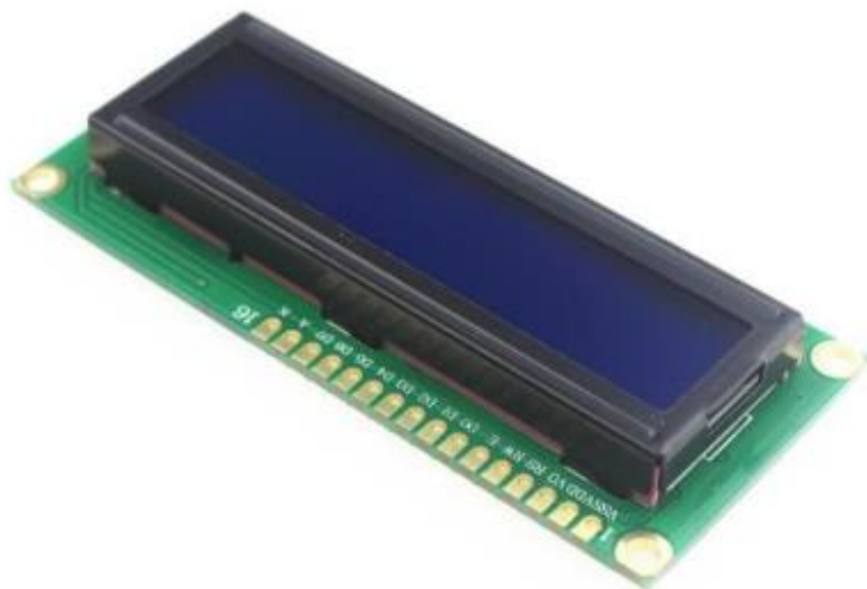
Рисунок 2.13 – Зовнішній вигляд LCD-дисплею 1602
