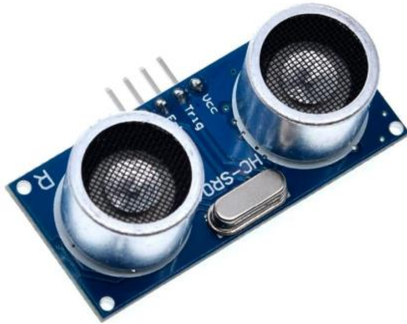
Рисунок 2.9 – Зовнішній вигляд датчика відстані HC-SR04
