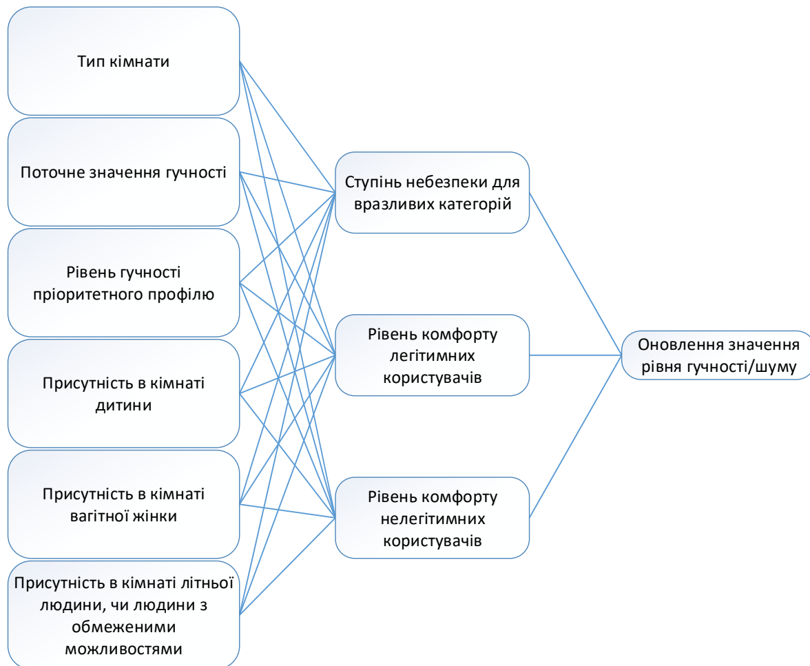
Рисунок 2.4 - Фрагмент дерева прийняття рішень для керування рівнем гучності мультимедійних систем в системі РБ
