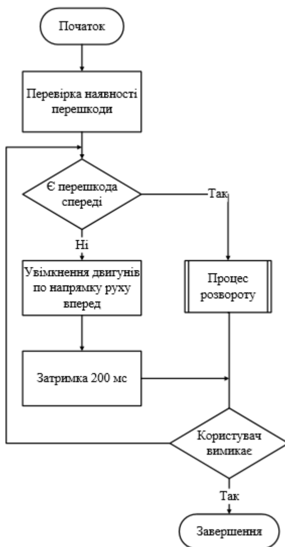
Рисунок 3.9б – Блок-схема основного алгоритму роботи СК РП
