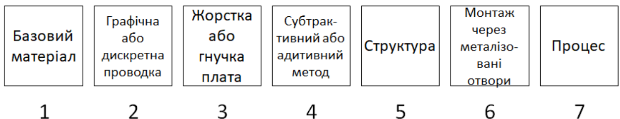
Рис. 1.26. Схема класифікації конструкцій друкованих плат
