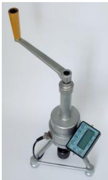
Рисунок 2.5 – Вимірювач методом відриву зі сколюванням ПОС-50МГ4,0
