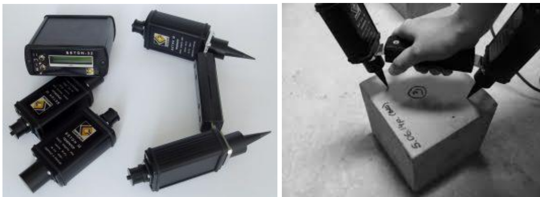
Рисунок 2.1 – Вимірювач міцності бетону ультразвуковим методом «Бетон-32»
