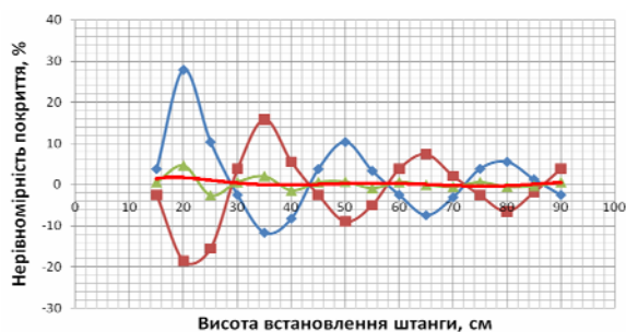
Рисунок 7 – Графічні залежності нерівномірності покриття при міжрядному обробітку з шириною міжрядь 0,7 м для розпилювачів \alpha_\phi = 120^\circ , які переміщуються: \blacklozenge – по осі рядка; \blacksquare – рядок розміщений по центру між розпилювачами; \blacktriangle – середнє значення; суцільна лінія – апроксимуюча крива
