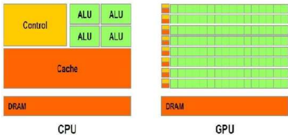
Рисунок 1.1 - Будова GPU та CPU. Зліва – CPU, праворуч GPU
