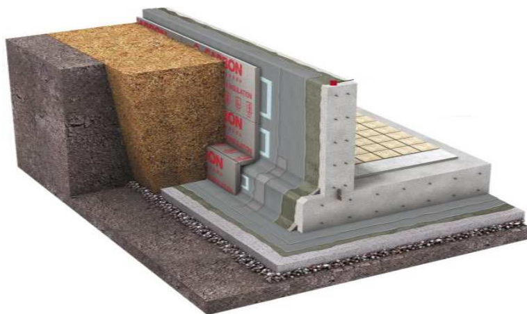
Рисунок 1.1 – Ізоляція підземної частини фундаменту
