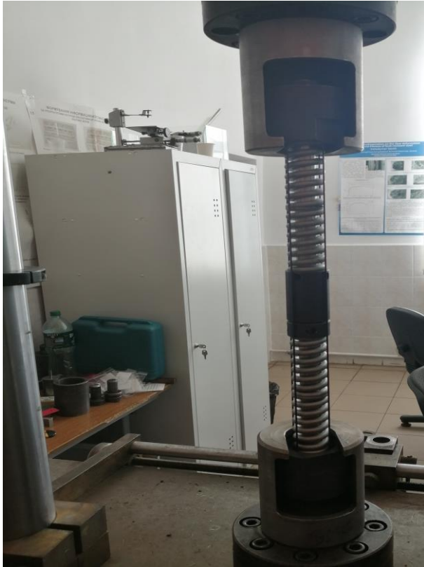
Рис. 7.11. Фото демпфувального пристрою встановленого на випробувальній машині СТМ 100: кріплення в затискачах – а та система вимірювання деформації і переміщення – б
