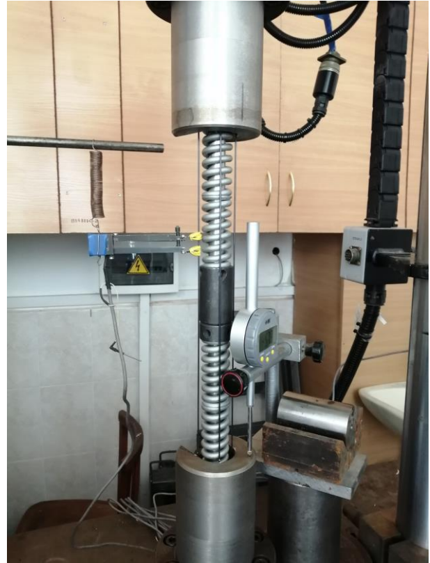
Рис. 7.11. Фото демпфувального пристрою встановленого на випробувальній машині СТМ 100: кріплення в затискачах – а та система вимірювання деформації і переміщення – б
