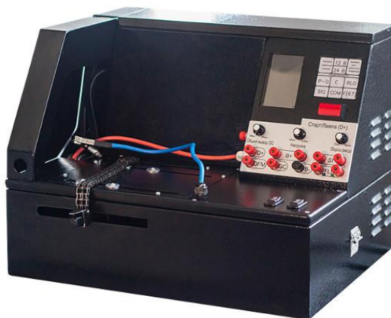
Рис. 3.3. Сучасний, багатофункціональний стенд перевірки генераторів.
