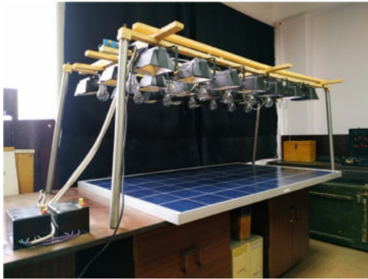
Рисунок 4.2 – Установка для досліджень характеристик сонячних панелей
