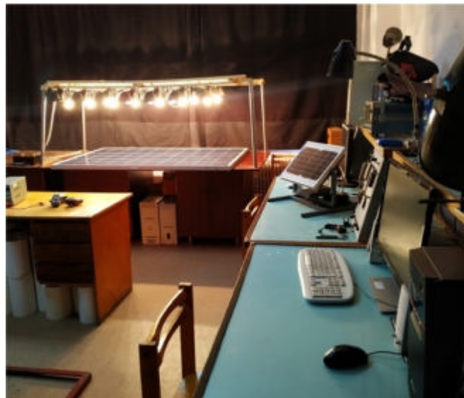
Рисунок 4.3 – Дослідження характеристик сонячної панелі у лабораторії сонячної енергетики ХНУ.
