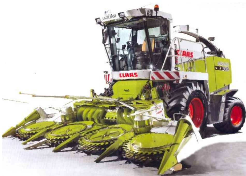
Рисунок 1.8 – Кормозбиральний комбайн JAGUAR - 840
