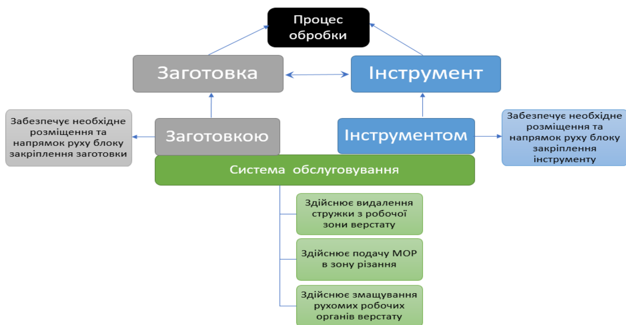
Рис. 3.6. Функціональна схема системи обслуговування шліфувальним верстатом
