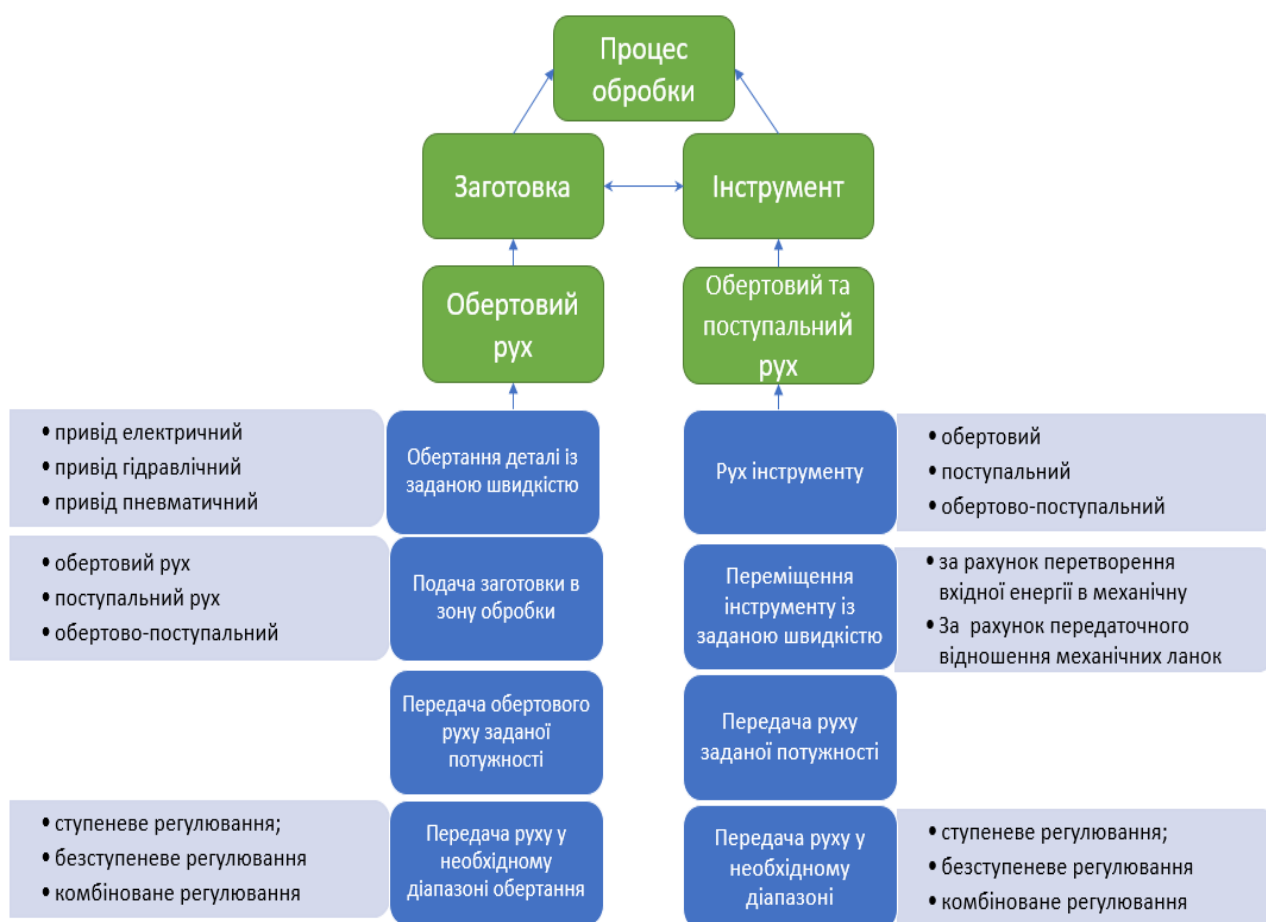
Рис. 3.2. Функціональна схема системи обробки шліфувального верстату
