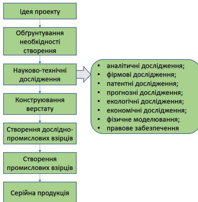
Рис. 1.2. Багатоцільовий підхід до проєктування ТС
