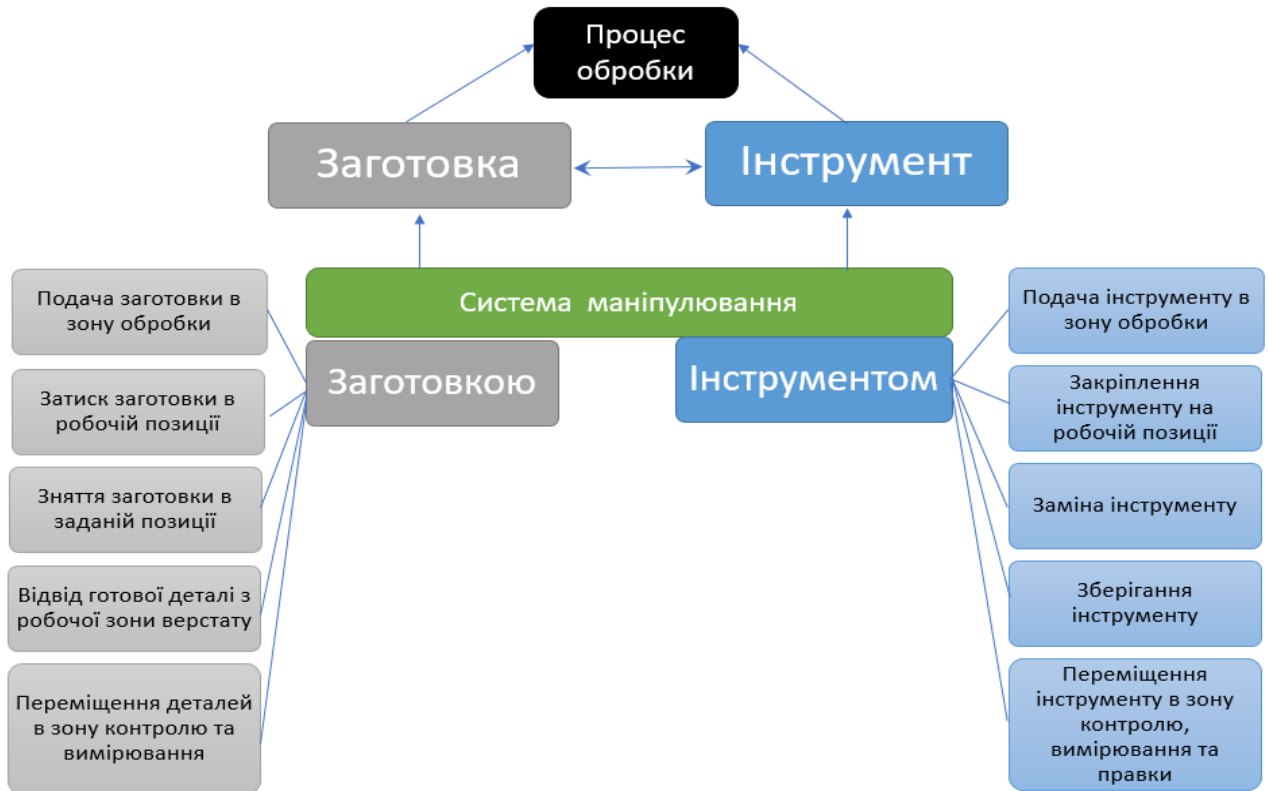
Рис. 3.3. Функціональна схема системи маніпулювання шліфувального верстату
