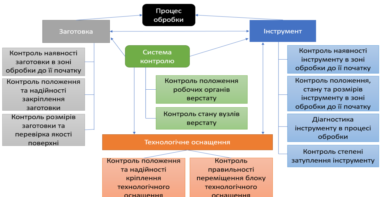
Рис. 3.4. Функціональна схема системи контролю шліфувального верстату
