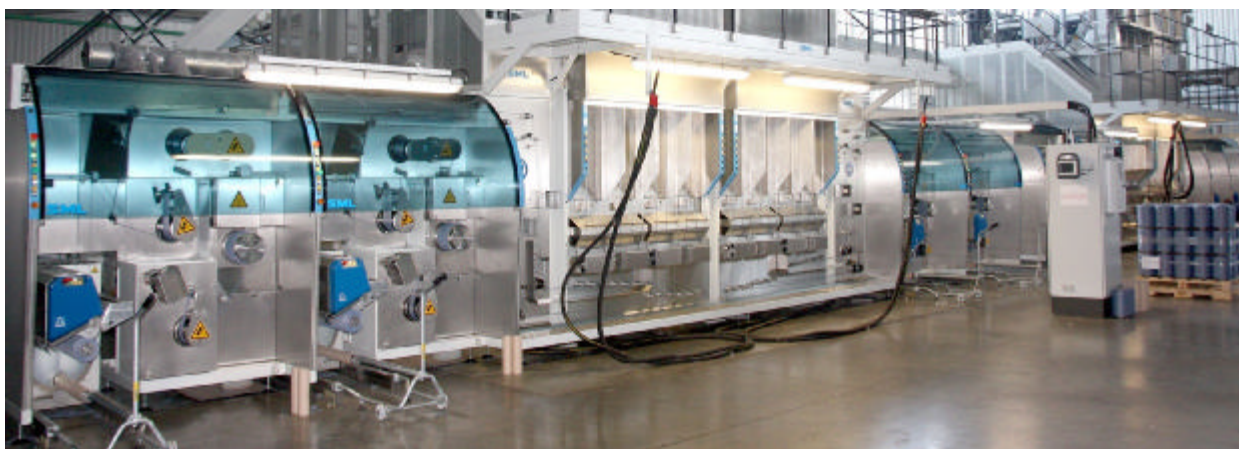
Рисунок 1.3 – Екструдер для виробництва поліпропіленової нитки на ТОВ «Карат»
