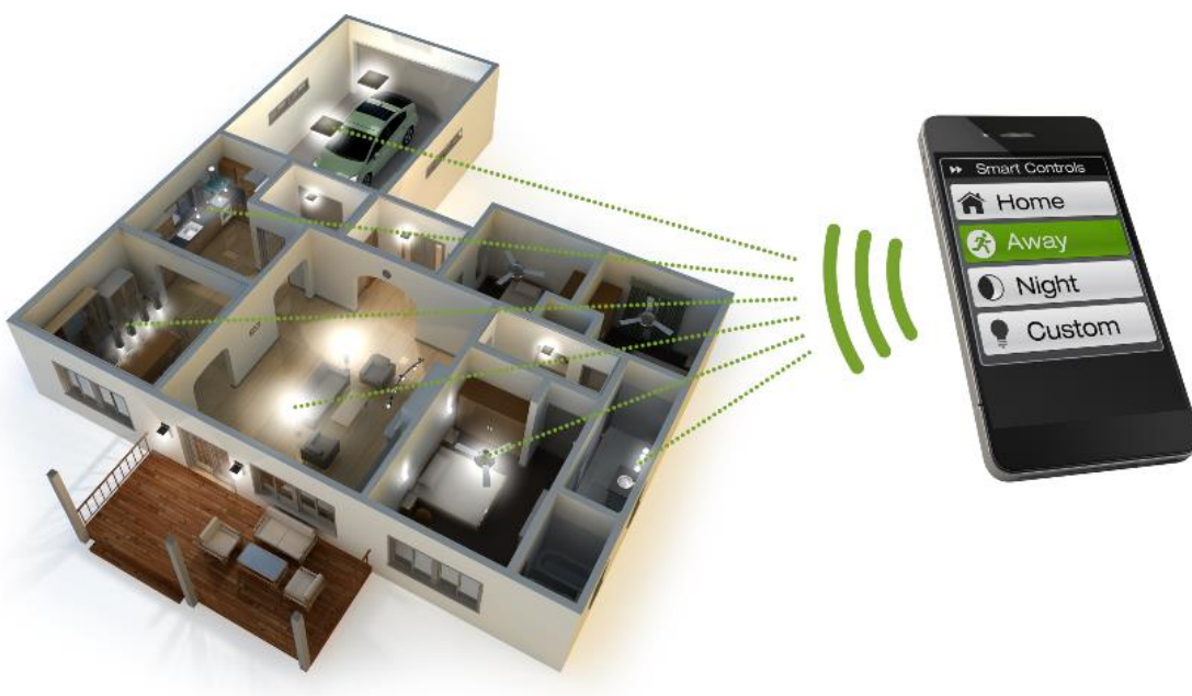
Рис.1.3. Управління освітленням розумного будинку за допомогою стандарту Z-Wave
