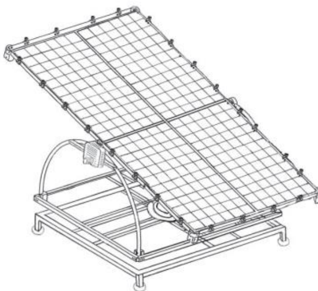
Рисунок 3.1 - Проект 2-координатної системи наведення сонячної панелі
