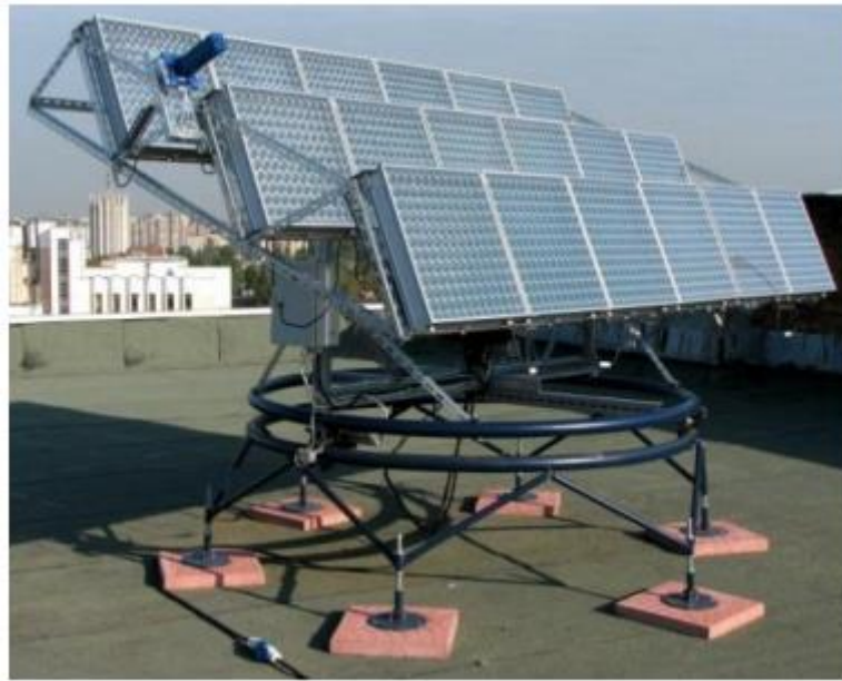
Рисунок 1.7 – Сонячна установка з оптичними концентраторами
