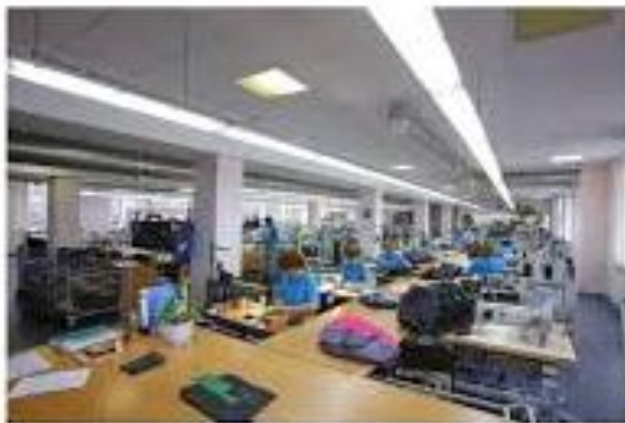
Рисунок 1.3 – Система комбінованого освітлення цеху пошиття одягу
