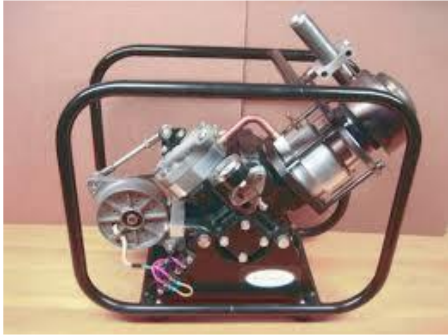
Рис. 1.9 Промисловий двигун Стірлінга потужністю 1 кВт
