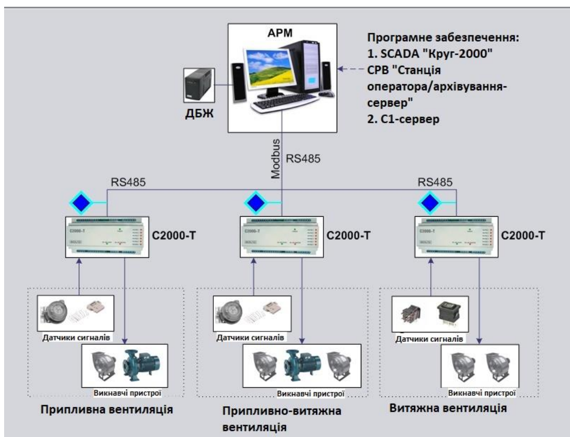
Рисунок 3.1 – Функціональна схема АСУ припливно-витяжної вентиляції
