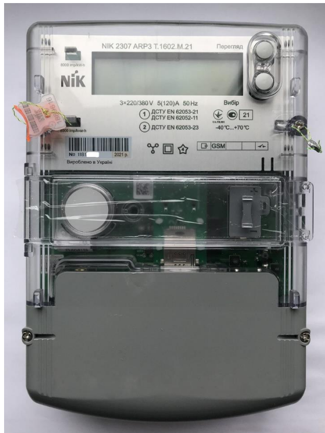
Рисунок 2.6 – Лічильник електроенергії NIK 2307 ARP3T.1602.M.21
