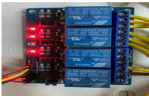
Рисунок 3.13 – Підключення клем 4-х канального реле
