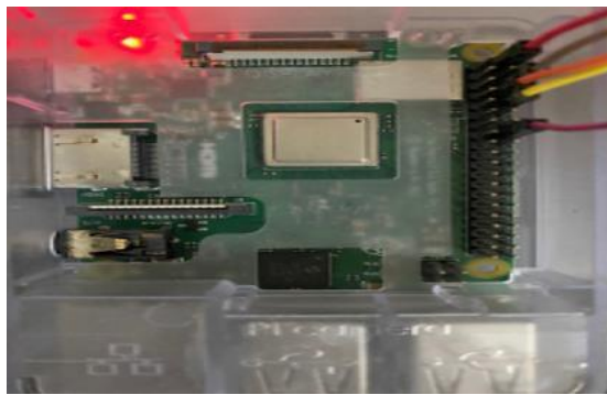
Рисунок 3.14 – Підключення проводів до Raspberry Pi
