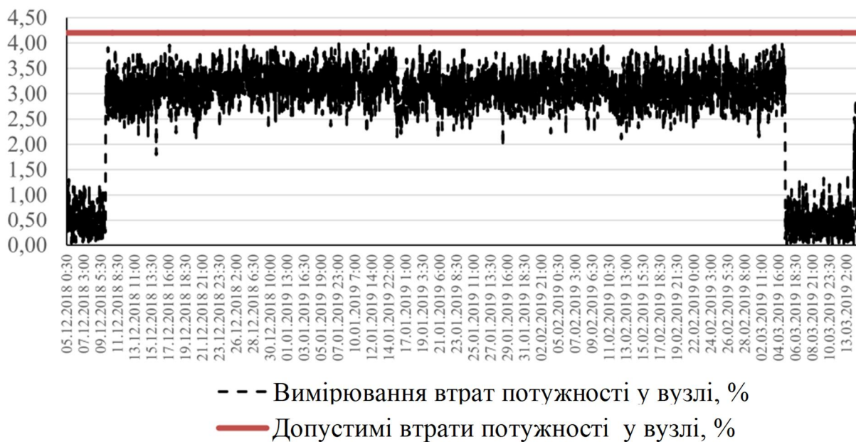
Рисунок 2.10 – Графік втрат потужності у вузлі ПЛ-110кВ "ПІВНІЧНА"
