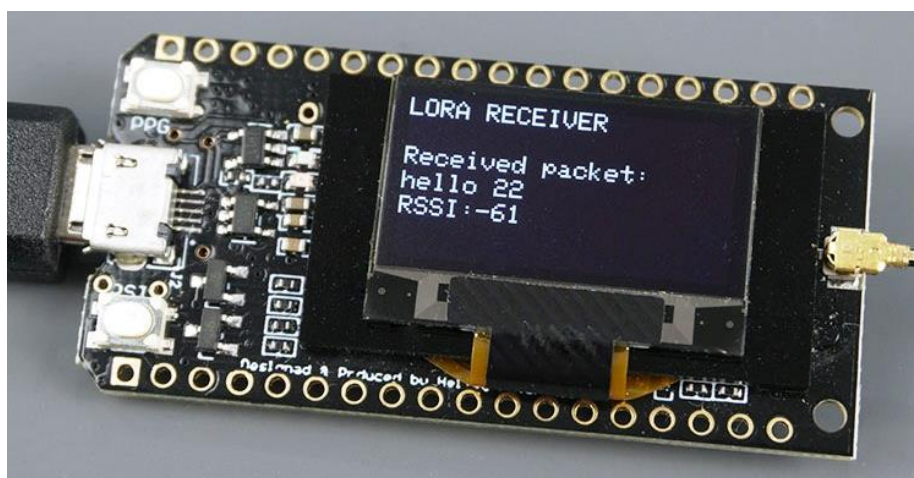
Рис. 3.18. Результат отримання інформаційного пакета модулем TTGO LoRa32
