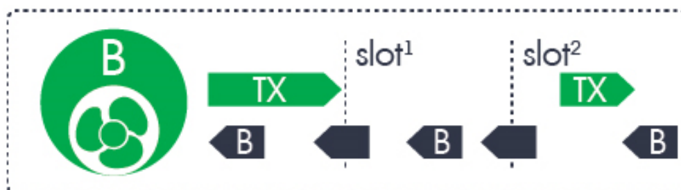
Рис. 2.4. Принцип обміну даними в мережі LoRa з використанням пристроїв «класу В»
