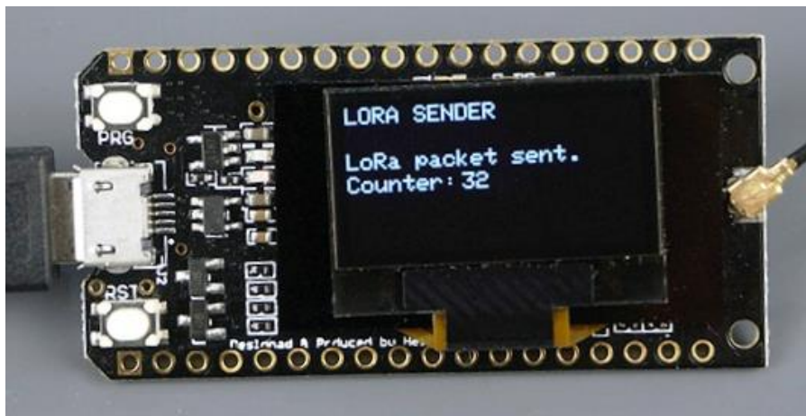
Рис. 3.16. Результат надсилання інформаційного пакета модулем TTGO LoRa32
