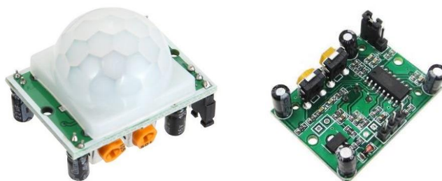
Рис. 3.10. Зовнішній вигляд давача руху HC-SR501
