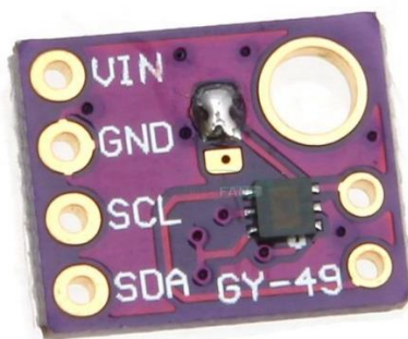
Рис. 3.8. Зовнішній вигляд модуля датчика освітленості GY-49 MAX44009
