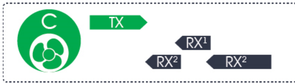
Рис. 2.5. Принцип обміну даними в мережі LoRa з використанням пристроїв «класу С»
