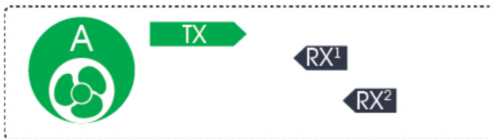
Рис. 2.3. Принцип обміну даними в мережі LoRa з використанням пристроїв «класу А»
