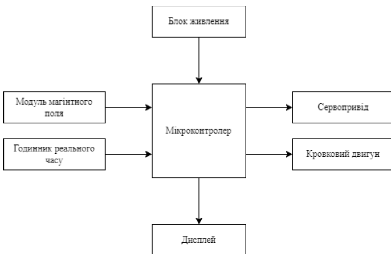
Рис. 2.1. Структурна схема архітектури сонячного трекера
