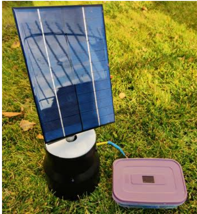
Рис. 3.4. Тестовий стенд сонячного трекера з двохосьовим позиціюванням
