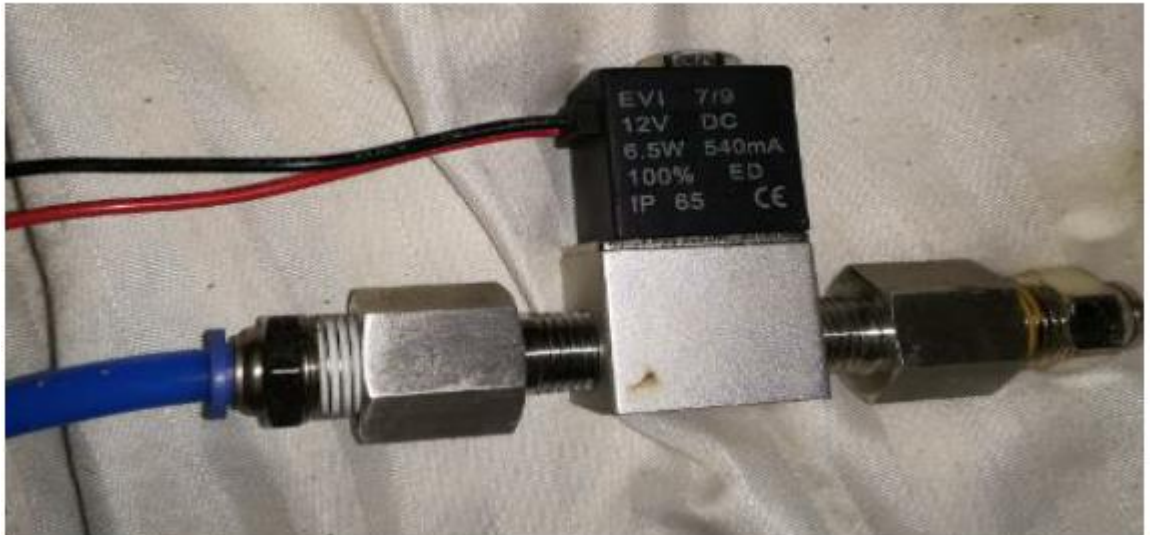
Рисунок 3.2 – Електромагнітний клапан 12 В постійного струму з підключеннями.
