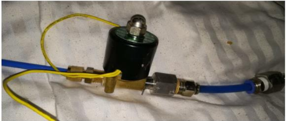
Рисунок 3.3 – Електромагнітний клапан 12 В постійного струму зі з'єднаннями.
