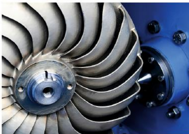
Рисунок 1.5 - Похило-струменева турбіна Turgo
