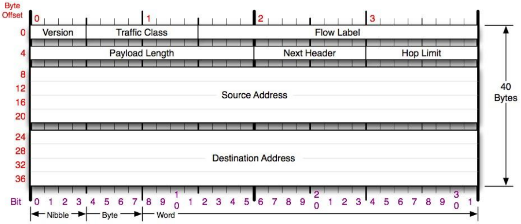
Рисунок 1.5 – Заголовок мережевого протоколу IPv6
