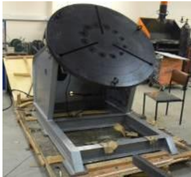
Рисунок 2.6 – Загальний вигляд маніпулятора МС - 5
